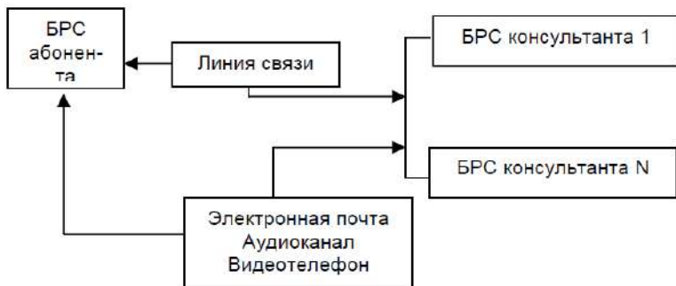
Рисунок 1. Принципиальная схема телемедицинской системы первой группы
