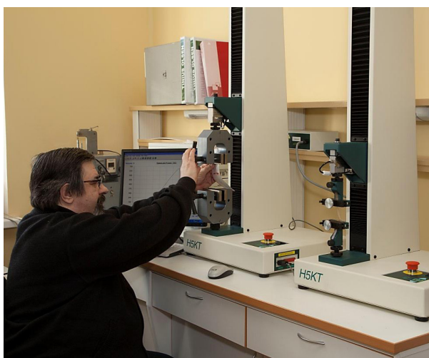
Андрей Борисович Требухин, сотрудник лаборатории средств индивидуальной защиты, проводит испытания текстильных материалов на прочность. Начало 2000-х годов
