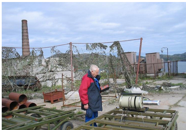
Измерение спектральных характеристик гамма-излучения у хранилища ЖРО на объекте СевРАО в губе Андреева
