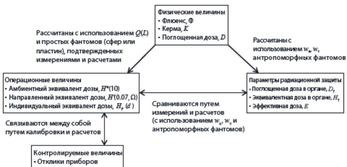
Рис. 4 – Концептуальная зависимость между физическими, нормируемыми и операционными величинами, используемыми для целей радиационной защиты (контроль внешнего облучения) [142]
