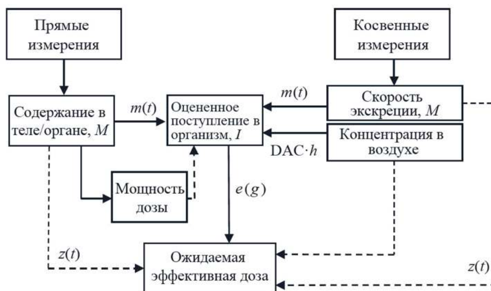
Рис. 5 – Общая схема оценки дозы внутреннего облучения на основе данных радиационного мониторинга [142]. Возможные альтернативные подходы к расчету показаны пунктирными линиями
