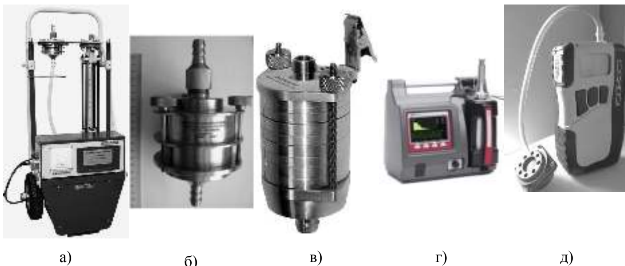
Рисунок 1 – а) импактор АИП-2 в составе установки ПУ-АИП-01Д; б) внешний вид импактора ФРТЧ; в) щелевой пятикаскадный импактор SKC Sioutas; г) электрический импактор низкого давления Dekati ELPI+; д) индивидуальный импактор ИРАМ с побудителем расхода Leland Pump.
