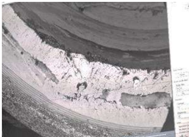
Рисунок 1 – дефекты в платформе титанового имплантата в результате эксплуатационной нагрузки.
