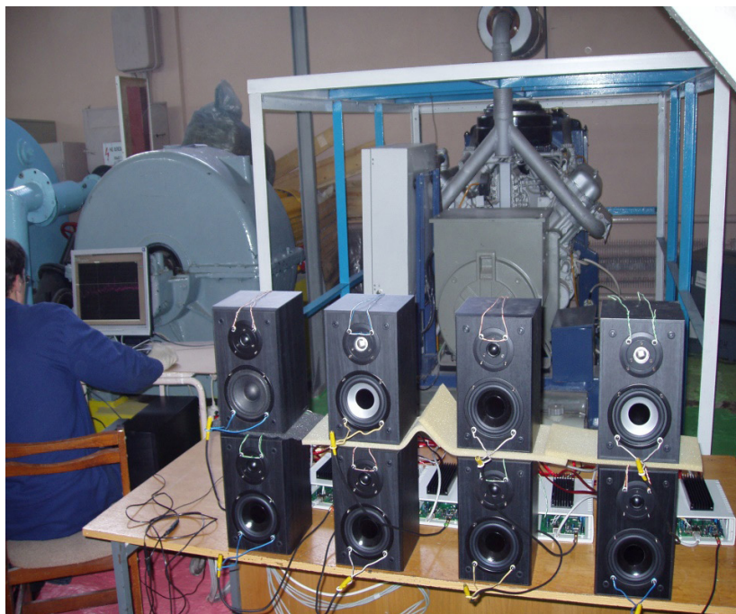
Рисунок 7.8. — Элементы системы активного гашения шума на фоне дизель-генератора
