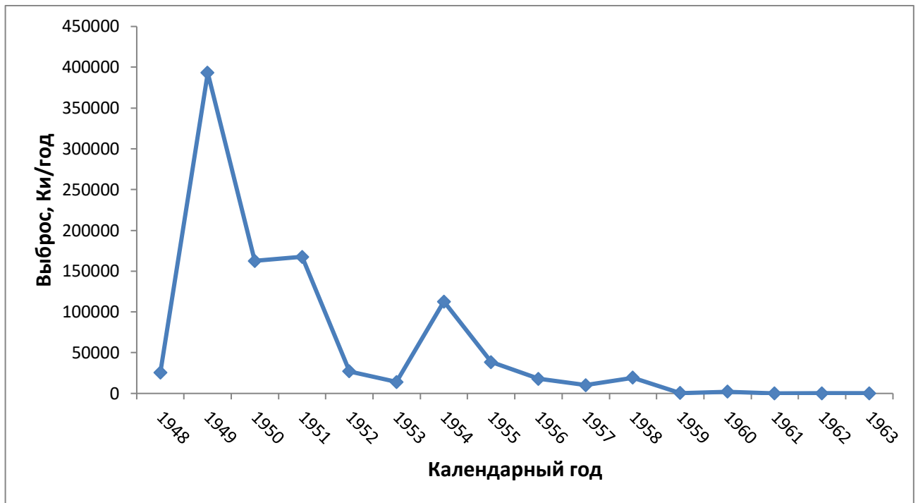
Рисунок 3.4 – Результаты реконструкции годовых выбросов ^{131}\text{I} в атмосферу из труб радиохимического завода за период 1948–1963 гг. (наиболее вероятные оценки) [4]
