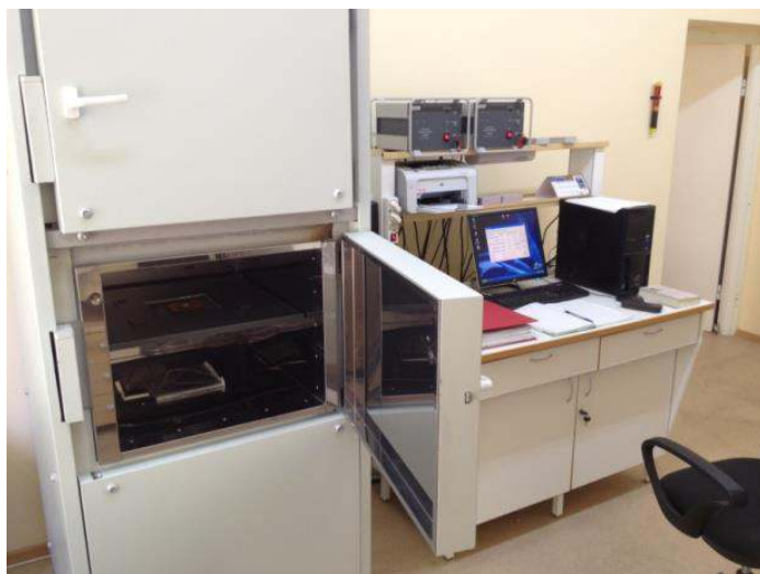
Рисунок 5 – Рентгеновская биологическая установка РУБ РУСТ-М1 (Россия)
