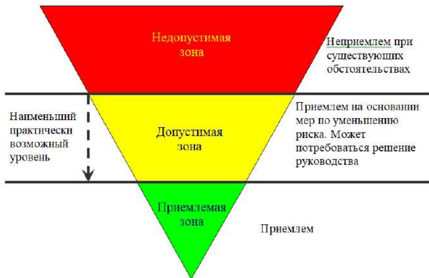
Рис. 8. Градация факторов риска с учетом степени их влияния на безопасность полётов [Safety Management Manual. Fourth Edition. ICAO, 2018. Doc 9859]
